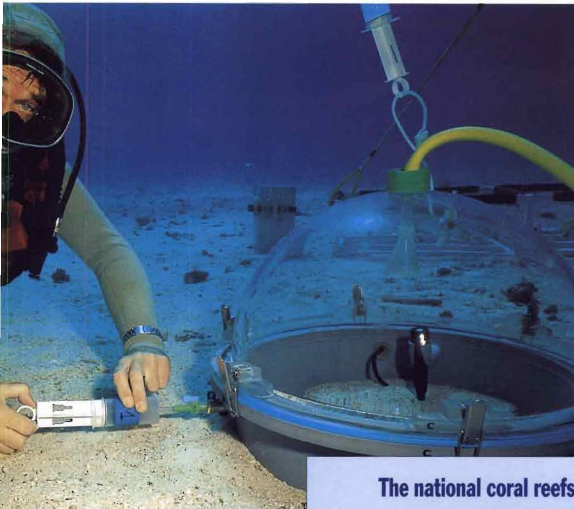
La mesure globale des flux de carbone à l'interface située entre la colonne d'eau et le fond est une donnée essentielle dans l'étude des transferts énergétiques. Des expériences d'incubation sous cloche sont réalisées en plongée sur les récifs coralliens et sur les fonds sédimentaires des lagons.
