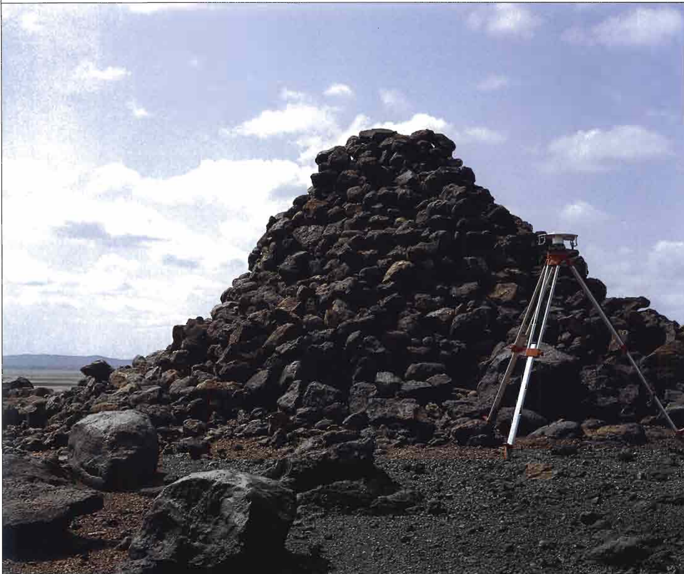
Station GPS (ASHTech M XII) installée dans la région de Djibouti lors d'une campagne de géodésie spatiale. Campagne IPG "Djibouti-Afar", novembre 1991 - Photo : J.C. Ruegg/IPG-CNRS
