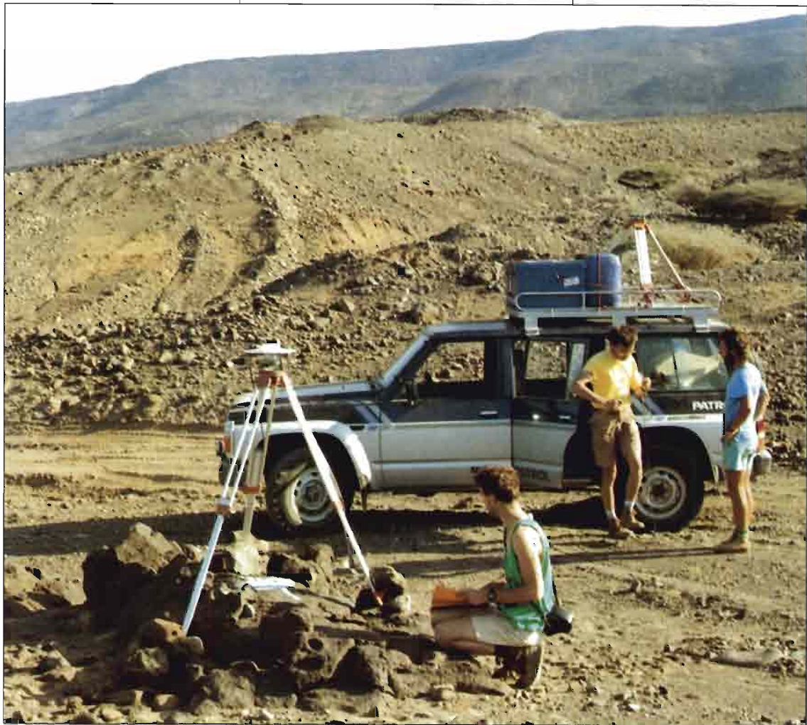
Station GPS (ASHTech M XII) installée dans la région de Djibouti lors d'une campagne de géodésie spatiale. Campagne IPG "Djibouti-Afar", novembre 1991 - Photo : J.C. Ruegg/IPG-CNRS
