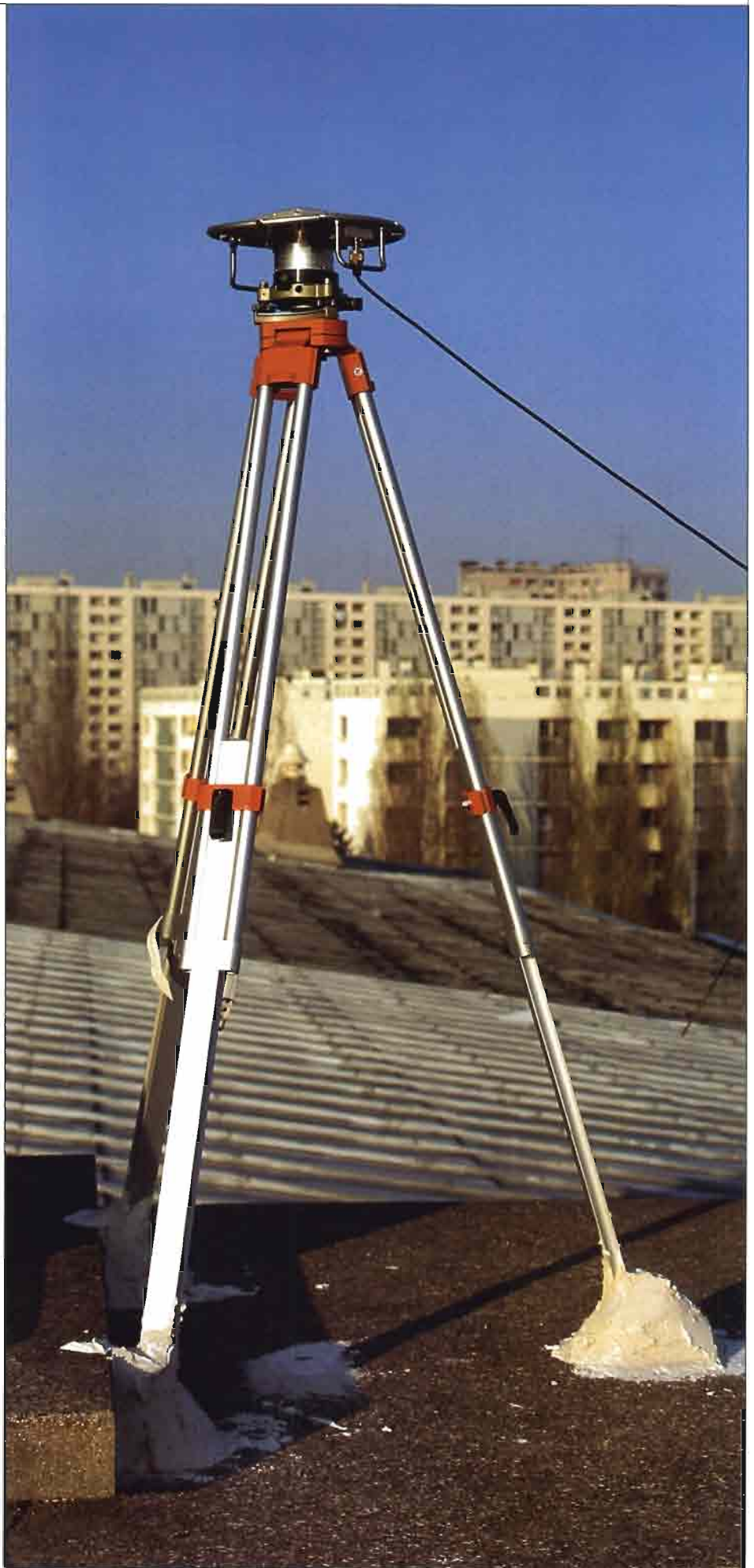
Antenne du récepteur GPS bifréquence (ASHTECH MD-X11), montée sur trépied sur le toit du centre Orstom de Bondy et utilisée pendant le mois de novembre 1991 comme station fiduciale pour une campagne de géodésie spatiale dans la région de Djibouti - Photo : S. Bonvalot
