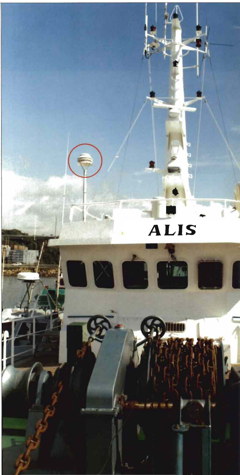
Le navire océanographique "Alis" de l'Orstom est équipé d'un système mixte de positionnement GPS/TRANSIT (MAGNAVOX MX1000-107) Photo : Orstom
