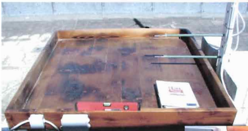
Lysimètre en place avec deux thermocouples
