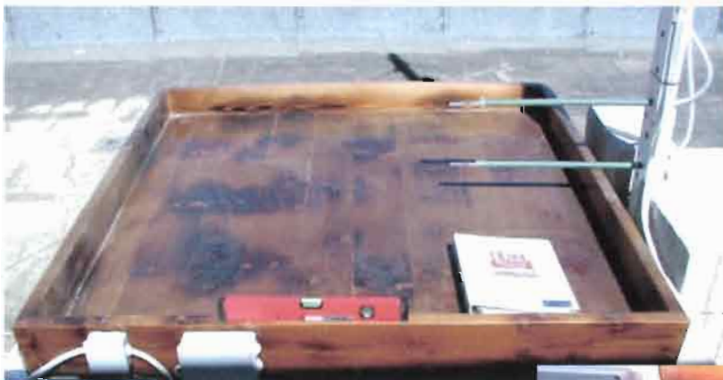
Lysimètre en place avec deux thermocouples
