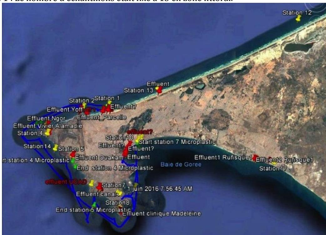
Figure 1 : plan d'échantillonnage réalisé en trois temps la campagne AWATox1 et AWATox2 et AWATox3. Pour les deux campagnes AWATox 2 & 3 uniquement les mesures faites au photomètre, avec la sonde multi paramètre et avec la benne à sédiment ont été réalisées.
