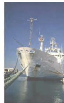
Le N/O L'Atalante équipé du mât instrumenté installé sur le pont avant pour la mesure des paramètres météorologiques et des flux turbulents. Le tangon horizontal à la proue est équipé pour la mesure du bilan radiatif de surface.
