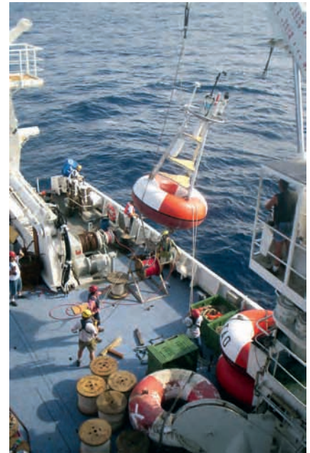
Activité sur le pont arrière du N/O L'Atalante pour la mise à l'eau d'une bouée ancrée du réseau PIRATA.
