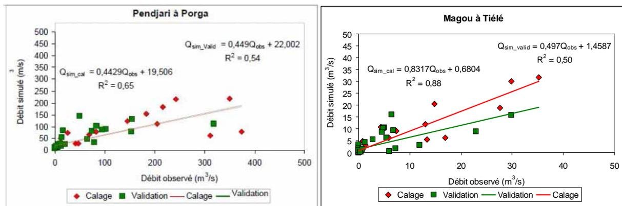
**Figure 9: Corrélation débits observés et débits simulés en calage (1973-1975) et en validation (1976-1978) dans les sous-bassins de la Pendjari à Porga et de Magou à Tiélé**
