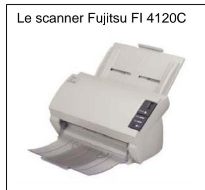
Les traitements de numérisation ont été réalisés avec un scanner de production Fujitsu FI 4120C. Il traite environ 20 pages à la minute, le format maximum possible est le A4. Le scanner fonctionne avec son logiciel spécifique qui est lui-même piloté par le logiciel Acrobat.
