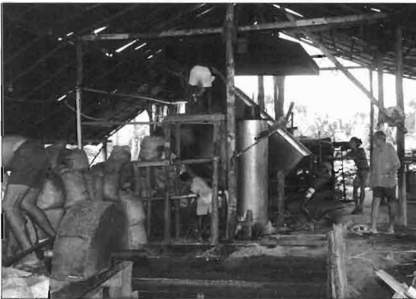
La distillerie de Presidente Figueiredo : le bois de rose est réduit en copeaux puis distillé selon des méthodes qui n'ont guère changé depuis le début du siècle. Sur la photo, le vidage de la cuve de distillation ; au centre, le condenseur à la base duquel sera recueillie l'huile essentielle.
