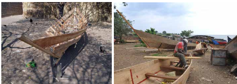
FIGURE 12 – Actuellement, l'ensemble des bateaux est construits avec des planches clouées ensemble. L'étanchéité est assurée par des baguettes de métal recouvrant l'étope goudronnée insérée en force entre les planches. À gauche, Speke Bay Lodge, Tanzanie (© IRD / D. Paugy), à droite, région d'Entebbe, Ouganda (© IRD / C. Lévêque)
