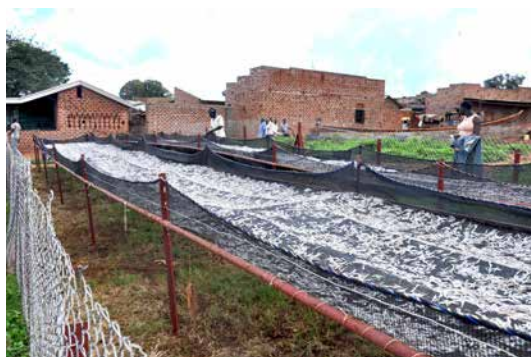
FIGURE 8 – On voit de plus en plus de séchoirs métalliques permettant d'isoler les dagaa du sol lors du séchage. Cette méthode permet d'obtenir des poissons séchés de meilleure qualité et de les vendre ainsi plus cher. Même si elle est de plus en plus utilisée, cette technique de séchage doit encore se confronter aux méthodes traditionnelles qui restent encore très enracinées. Beaucoup de villageois pensent encore, en effet, que c'est la chaleur du sol qui contribue à accélérer le séchage des dagaa 7 . Débarcadère de Kikondo, Ouganda (© IRD / C. Lévêque)
