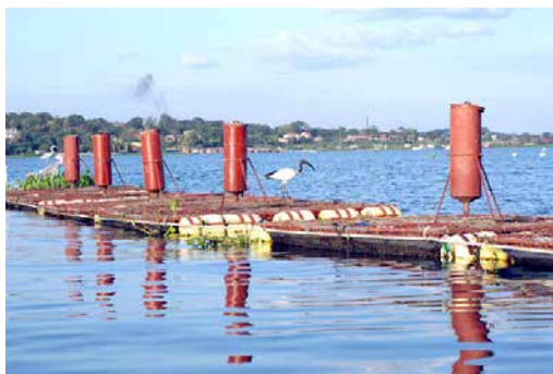
FIGURE 2 – Production en cages de tilapias du Nil ( Oreochromis niloticus ). Ces cages de la société SoN sont disposées à quelques dizaines de mètres du bord du lac Victoria, dans le fond Jinja, Ouganda. Elles sont protégées par un grillage de fines mailles pour éviter la prédation par les nombreux oiseaux qui souhaiteraient bénéficier d'un bon repas comme le montre le cliché. Les longs fûts verticaux sont des réserves de nourriture qui est distribuée à la demande lorsque les poissons actionnent un levier qui plonge jusque dans la cage (© IRD / D. Paugy)
