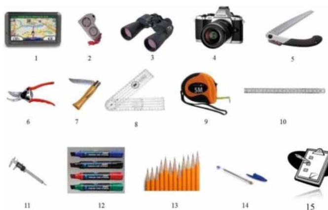
Fig. 4.3 : Matériels techniques nécessaires pour les mesures. (1) GPS, (2) clinomètre, (3) paire de jumelles, (4) appareil photo numérique, (5) scie d'arboriculture, (6) sécateur, (7) couteau, (8)
