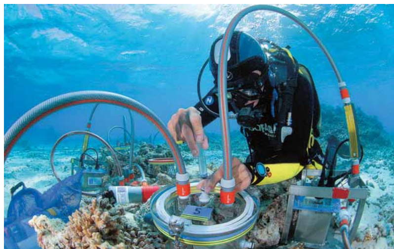
Incubations de colonies coralliennes dans des enceintes permettant de tester directement sur le récif l'effet d'un apport en nickel ou en cobalt sur la calcification et la photosynthèse des coraux. © CNRS/E. Amice
