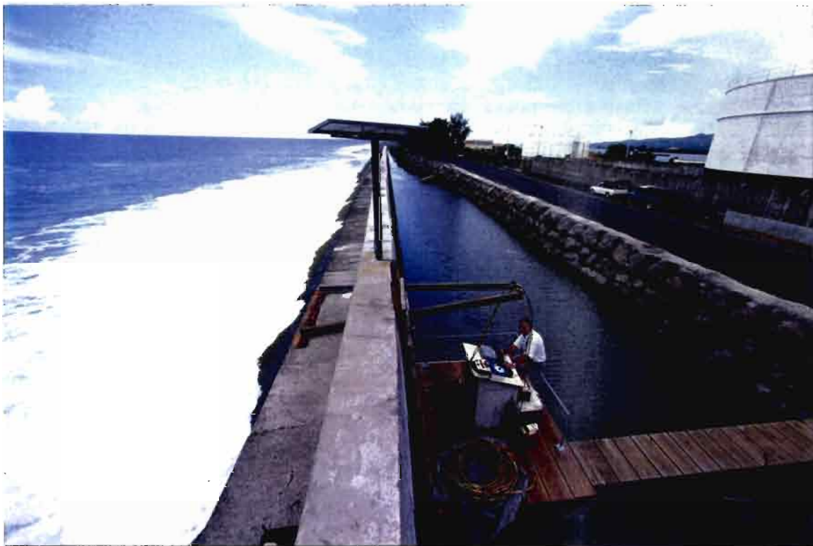
Planche 2: Le forage P7 est actuellement équipé d'un panneau solaire alimentant des batteries permettant des mesures au semi continu des caractéristiques thermo-halines et de la composante verticale de l'eau interstitielle récifale. Les pompages d'eau interstitielle sont faits sur une base mensuelle avec un polytube 12 voies amovible.
