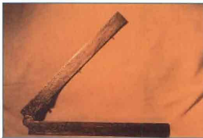
Compas de proportion signé LESNEL après traitement. Egalement appelé pied du Roi, c'est un instrument de mesure et de calculs. (P. Larue).
