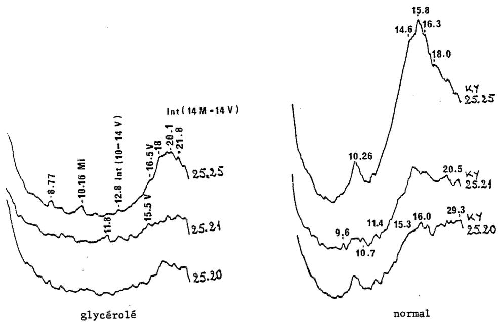
Fig. 37 - Diffractogrammes de rayons X de fractions argileuses du profil KY25 (agrégats orientés)
