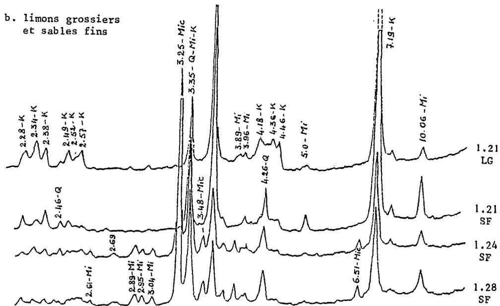
Fig. 15 - Diffractogrammes de rayons X des fractions granulométriques grossières du profil KY1 (diagrammes de poudre)
