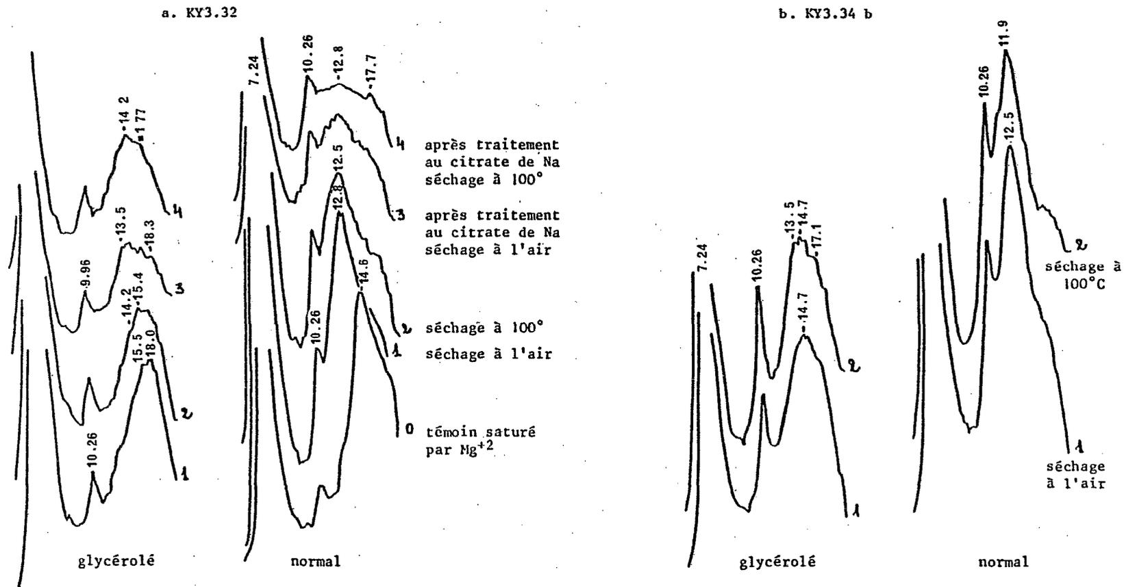
Fig. 25 - Diffractogrammes de rayons X de fractions argileuses du profil KY3, saturées par  $K^+$  (agrégats orientés)
