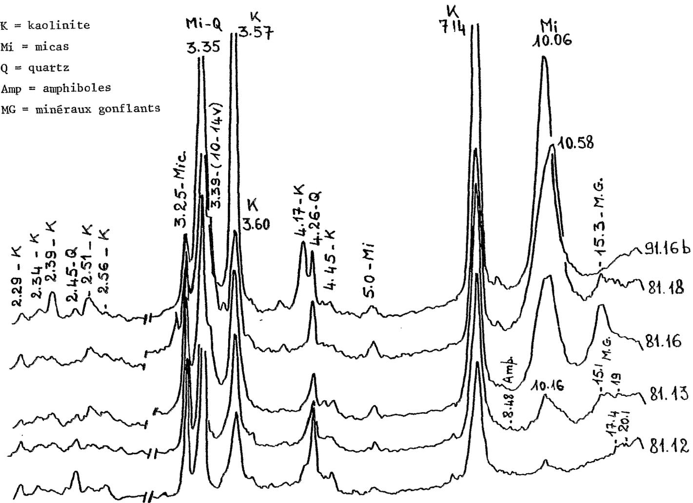
Fig. 58 - Diffractogrammes de rayons X du profil BK81 et de l'arène mésocrate du profil BK91 (91.16b) diagrammes de poudre de terre totale
