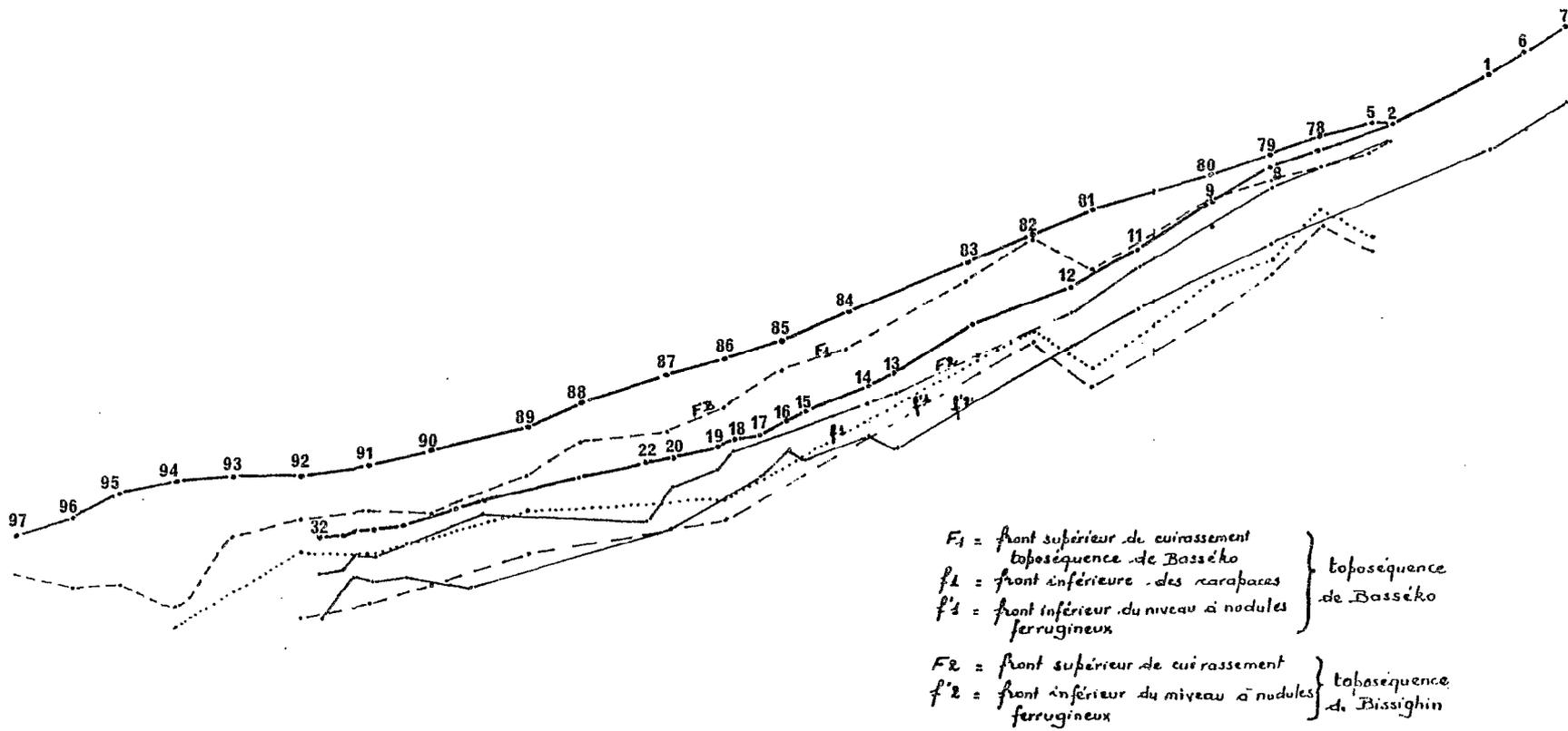
Fig. 55 - Comparaison des fronts de cuiressement en direction des collecteurs principal et secondaire
