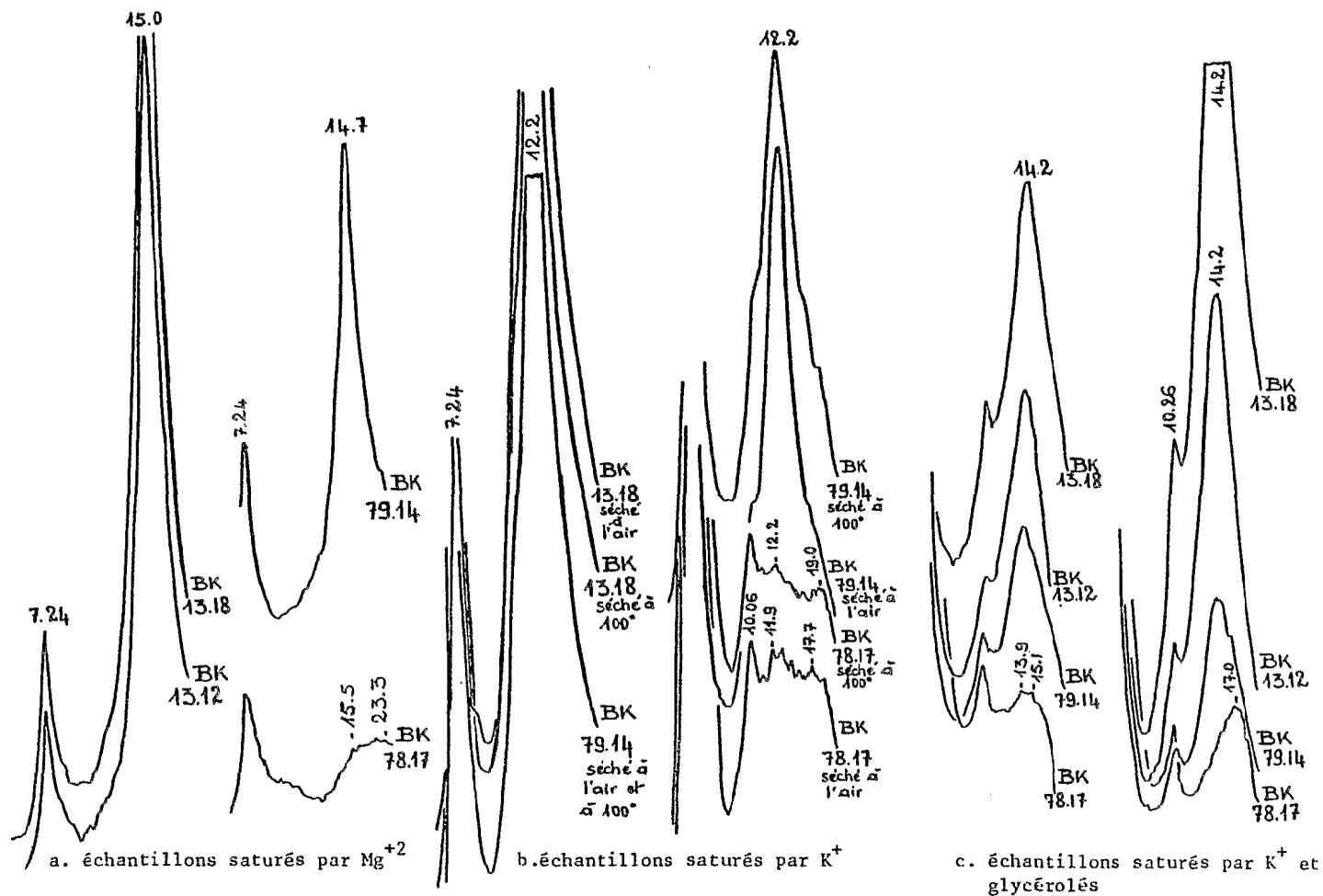
Fig. 50 - Diffractogrammes de rayons X de fractions argileuses des profils BK13, BK78 et BK79 (agrégats orientés)
