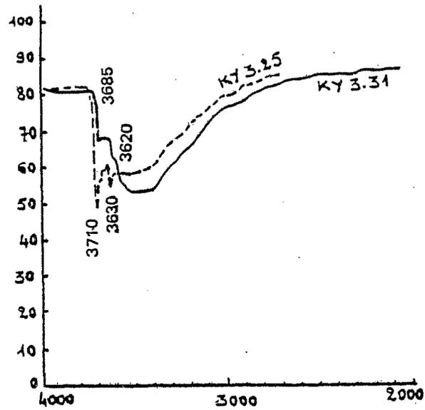
Fig. 22 - Spectre d'absorption infra-rouge de biotites du profil KY3
