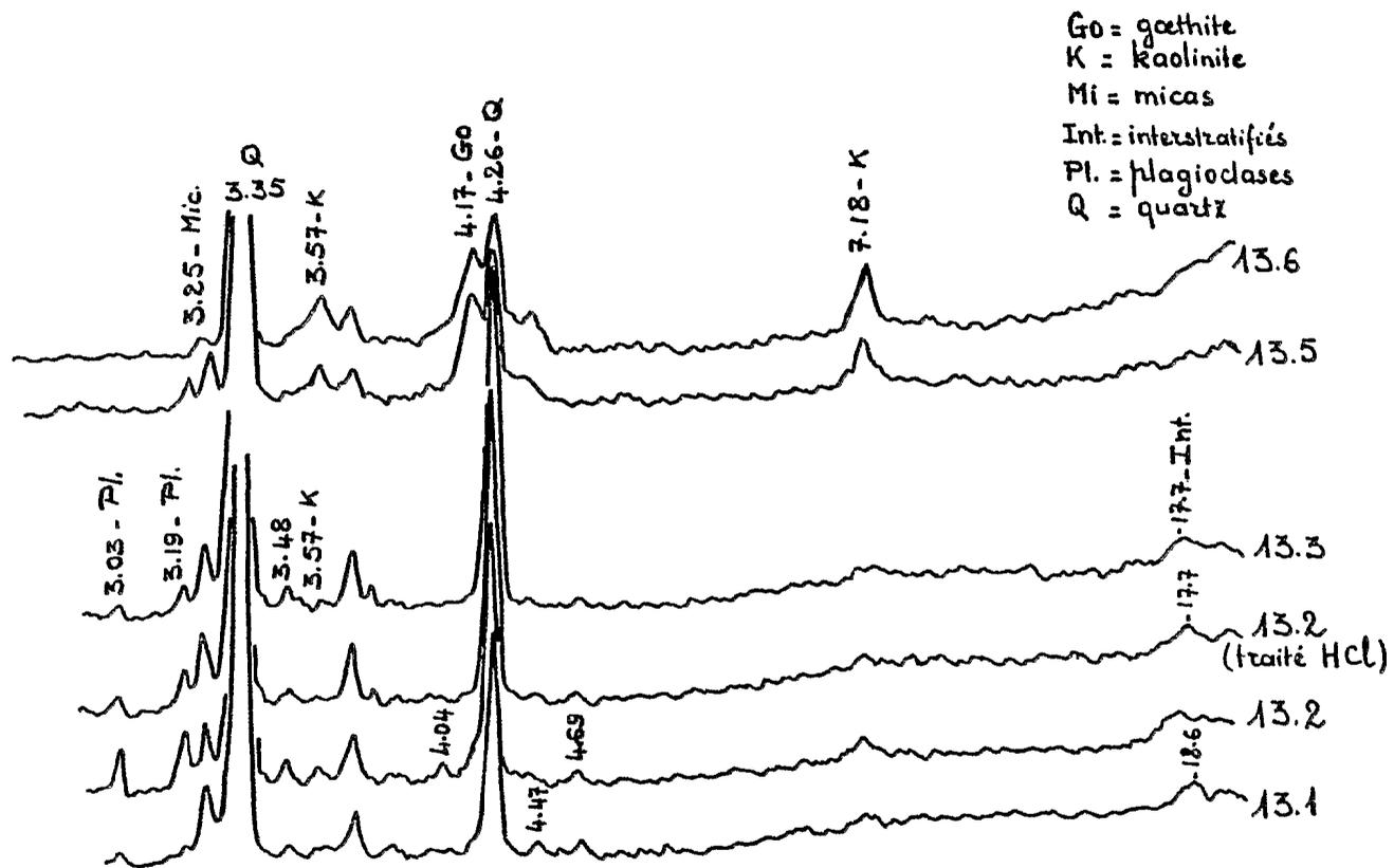
Fig. 47 - Diffractogrammes de rayons X de terre totale du profil BK13 (partie supérieure)
