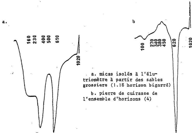
Fig. 17 - Diagrammes d'analyse thermique différentielle d'échantillons du profil KY1 (analyse réalisée sur échantillon total)
