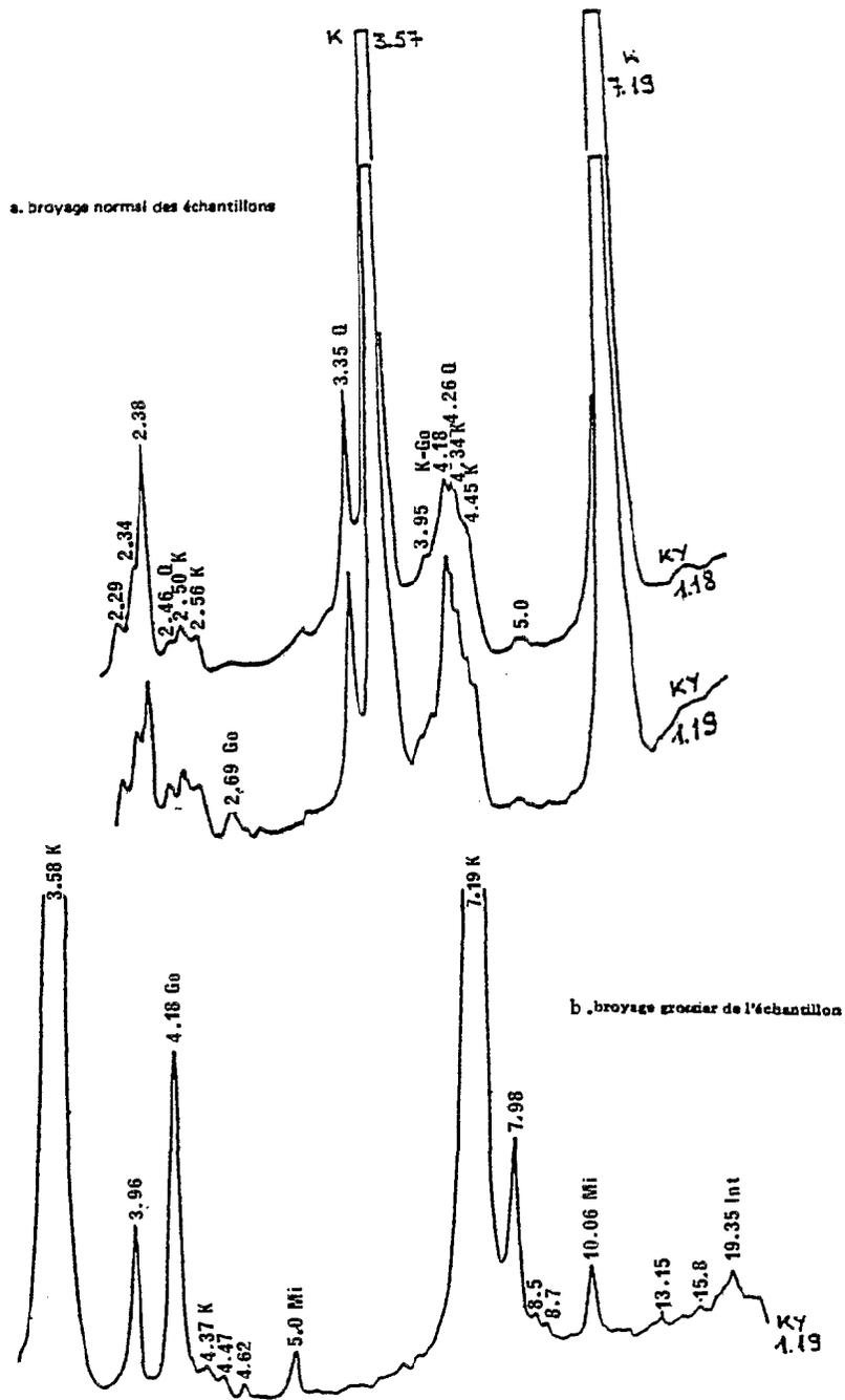
Fig. 16 - Diffractogrammes de rayons X de micas du profil XY1 isolés à l'éluutriomètre (diagramme de poudre)
