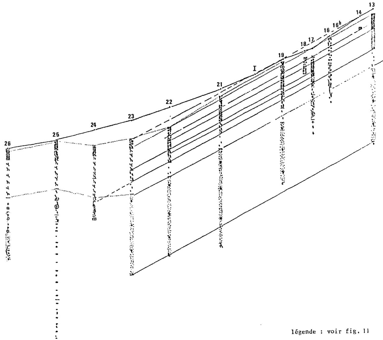
Fig. 31 - Relation entre les différents niveaux indurés et les matériaux sous-jacents
