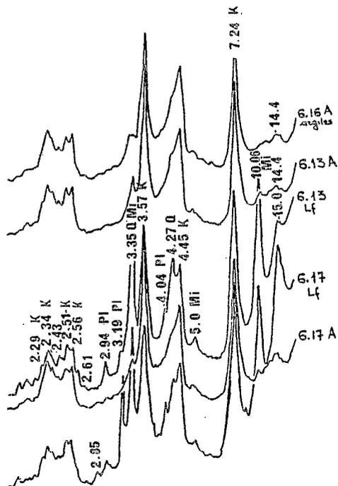
c. fractions argileuses agrégats orientés normal - glycérolé - chauffé à 500°C
