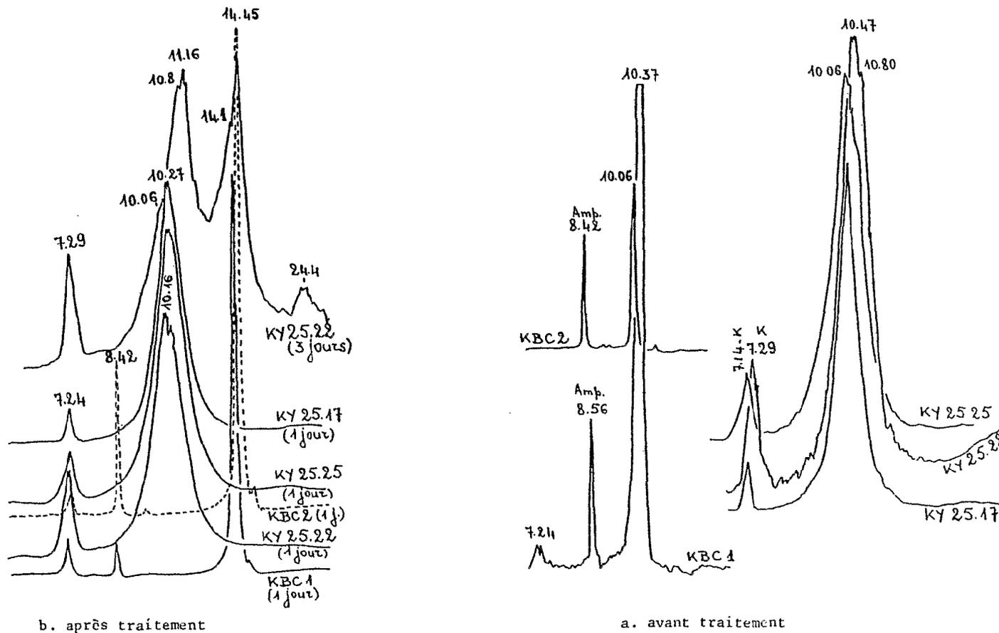
Fig. 38 - Aptitude à l'ouverture de micas du profil KY25 par traitement au  $MgCl_2$ . Comparaison avec les micas extraits des roches affleurantes (KBC1 et KBC2)
