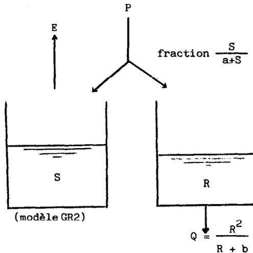
L'évaporation est puisée, sans autre limitation que  $S = 0$ , dans le réservoir sol dont le contenu en eau est S. Le paramètre a s'exprime en mm et ne dépend pas de l'intervalle de temps du modèle (c'est-à-dire le pas de temps des entrées, en général le jour).
