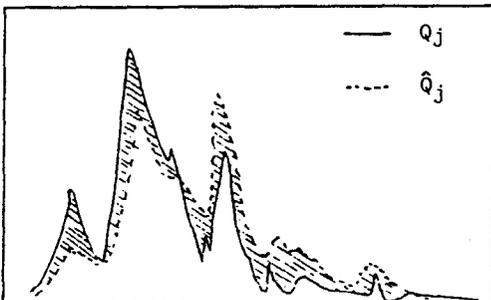
La "meilleure" formule semble encore être celle qui est la plus simple, c'est-à-dire la superficie de la zone comprise entre la courbe des  $Q$  et celle des  $\hat{Q}$ .
