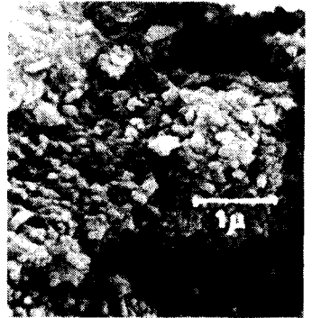
d. Batonnets trapus d'halloysite de Balengou (M.E.B.)
