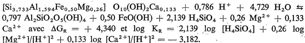
L'équation de transformation de la montmorillonite aluminoferrifère en montmorillonite magnésienne s'écrit :
