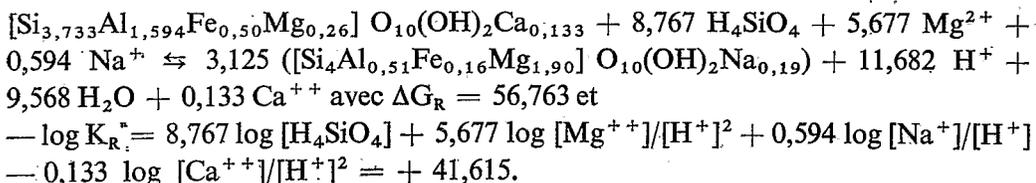
L'équation de transformation de la montmorillonite magnésienne en kaolinite et goëthite s'écrit :
