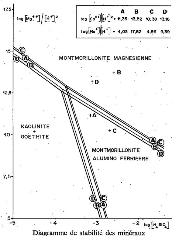
Quatre analyses chimiques d'eaux prélevées dans les dépressions bordières du lac Tchad sont utilisées pour illustrer les domaines de stabilité des montmorillonites. Dans le diagramme présenté, la position des points figuratifs de ces eaux doit être située par rapport aux droites d'équilibre qui sont à la même cote ( $\log [\text{Ca}^{2+}] / [\text{H}^+]^2$  et  $\log [\text{Na}^+] / [\text{H}^+]$  identiques).
