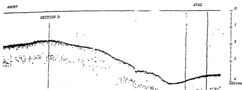
Fig. 4. — Profil en long près de l'embouchure mettant en évidence la remontée de fond au niveau de la section B.
