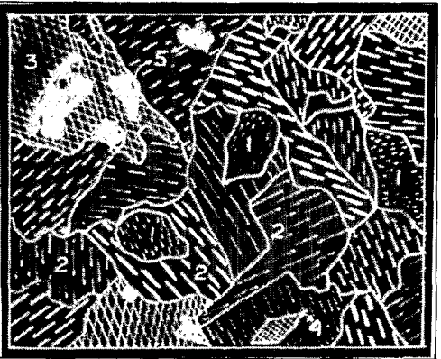
Esquema 1 – Rocha alcalina sã. Feldspatos potássicos (2) (ortoclásio e micropertita), hornblenda (3), nefelina (1), eventuais sodalitas, opacos (5), titanita (4), fluorita e raras aegerinaugitas. Seção PQA 17c, 25 X, LP
