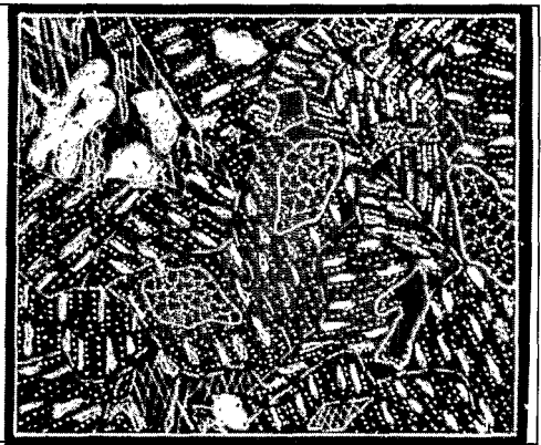
Esquema 2 – Bauxita friável. Gibbsita microcristalina ao longo dos planos de clivagem e contatos interminerais. Nefelinas sem preservação da cristalinidade (formação dos “favos de abelha”). Hornblendas (núcleo de vários cristais) em alteração formando auréola de difusão de hidróxidos de Fe ao redor do cristal. Fundo matricial constituído de gibbsita criptocristalina (isotrópica) nos núcleos dos FK e ao longo das discontinuidades. Seção PQA 17a, 25 X, LP
