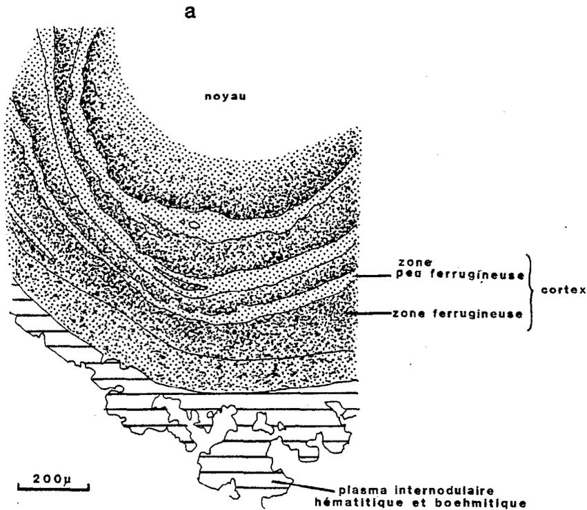
Figure 44: Individualisation d'une concrétion alumino-ferrugineuse par cortification interne dans un nodule "plasmique".
