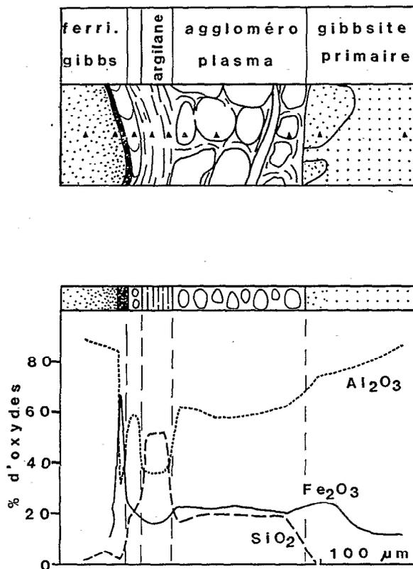
Figure 19: Microanalyses chimiques réalisées suivant une coupe transversale dans un tubule.
