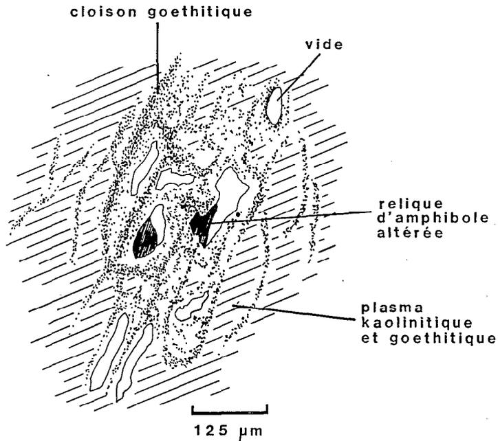
Figure 30: Altération de l'amphibolite en isaltérite kaolinitique.
