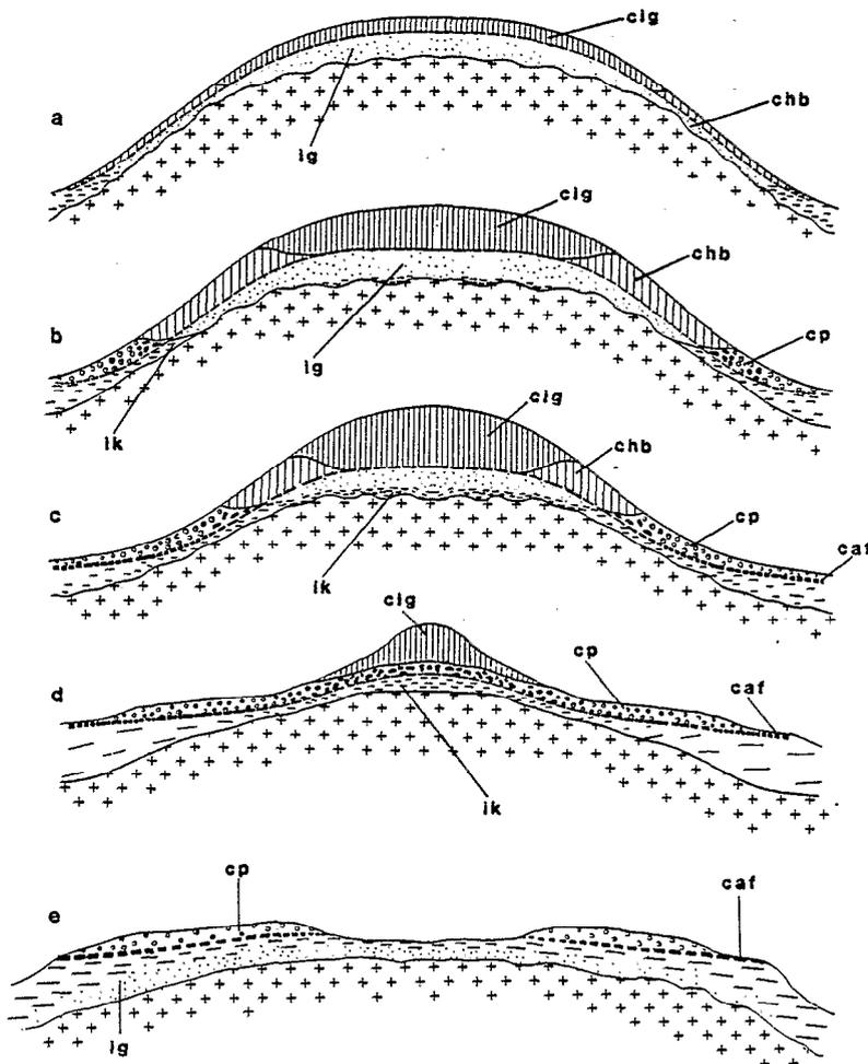
Figure 73: Schéma des évolutions du cuirassement et du façonnement des aplanissements sur un interfluve dans la région de Lakota.
