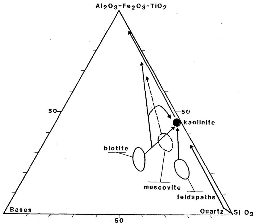
Figure 22: Altération différentielle des minéraux
