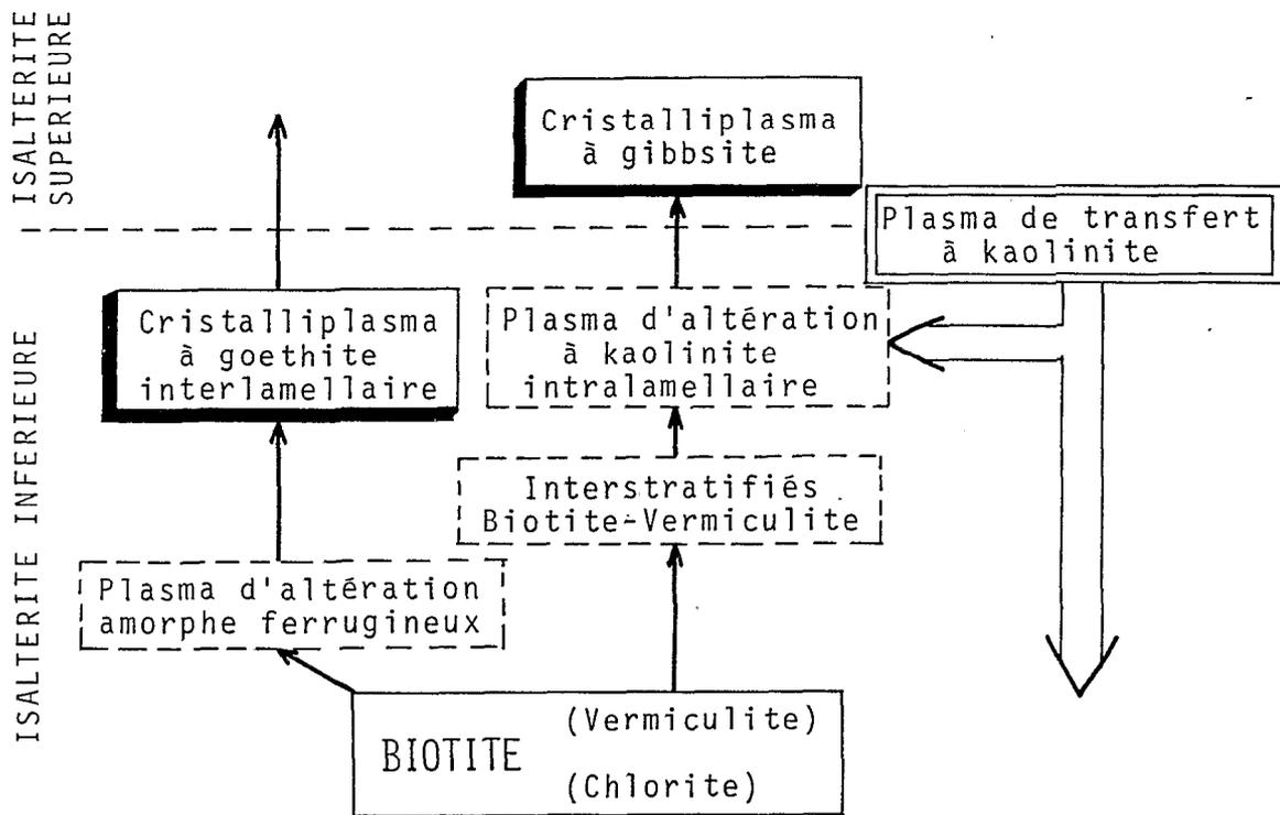
Figure 15: Altération des biotites dans l'isaltérite inférieure. Les différents plasmas et les transformations minéralogiques.
