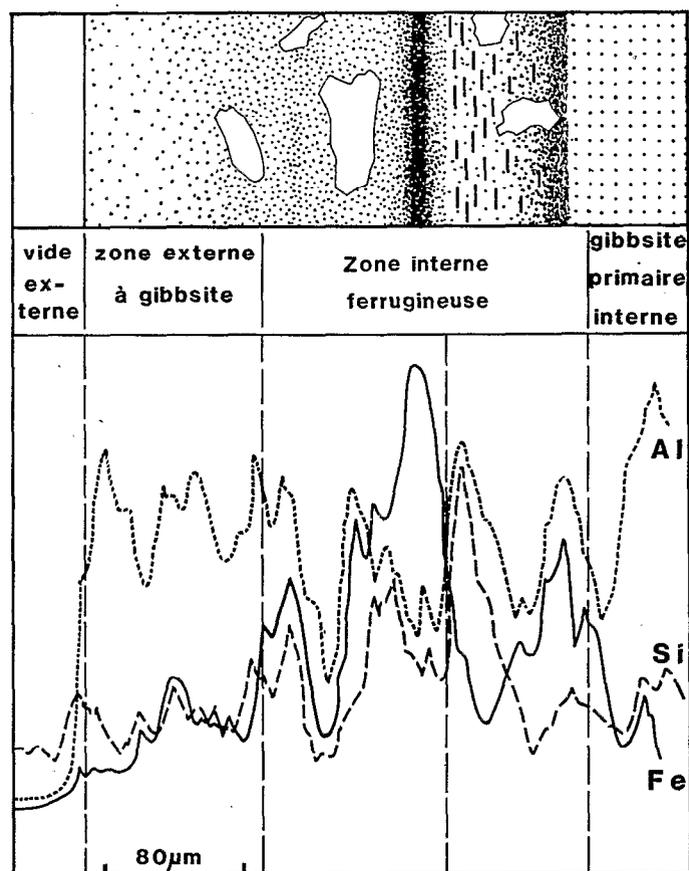
Figure 18: Distribution relative des éléments Al, Si, Fe suivant une traversée effectuée à la microsonde dans un cutane à plasma argilo-ferrugineux.
