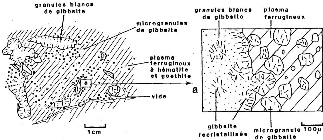
Figure 34: La cuirasse granulaire. Le plasma ferrugineux envahit le plasma gibbsitique, isolant des microgranules résiduels de gibbsite.
