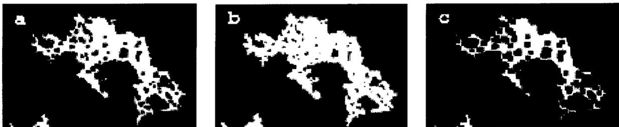
Figure 3.1 : Erosion (c) et dilatation (b) d'une image binaire (a)
