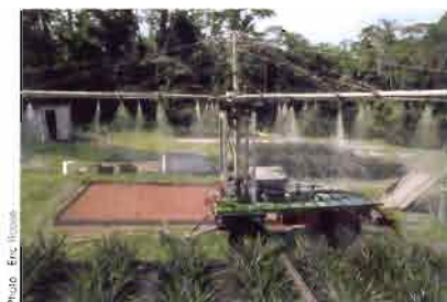
Simulateur de pluie type Swanson sur les parcelles d'érosion d'Adiopodoumé en Côte d'Ivoire.
