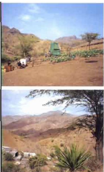
Vallée de Godim dans l'île de Santiago au Cap-Vert. Test au simulateur de pluie de l'effet paillage sur le ruissellement.
