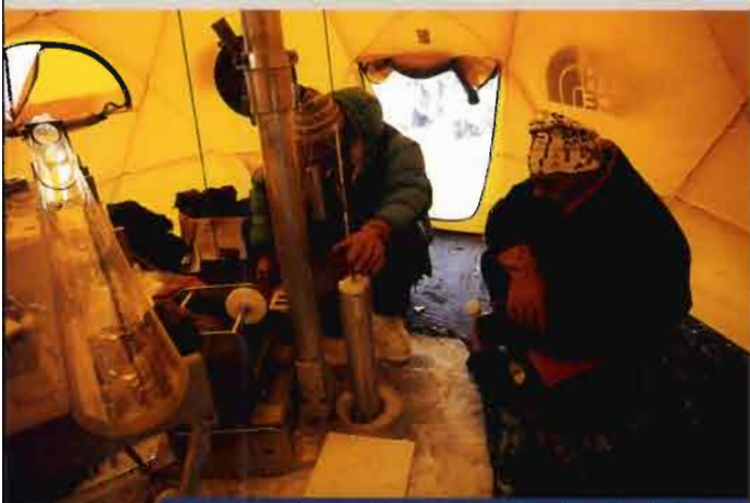
Le carottier en action dans la tente de forage.
