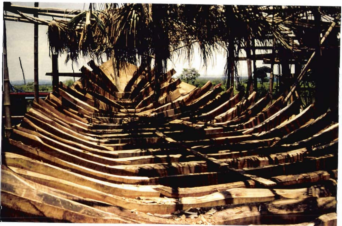
Moyen senneur en construction.
