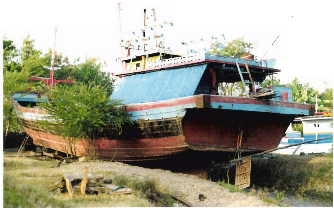
Grand senneur type cungking (poupe carrée) avec lampes mercury.
