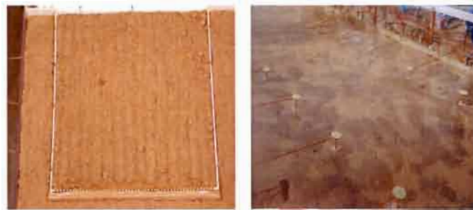
Figure 1 : Vues de la surface du sol. Avant la simulation de pluie (à gauche). Après la simulation de pluie (à droite).
