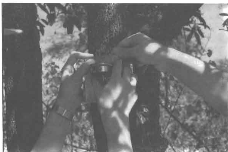
Fig. 2.- Control de crecimiento radial en troncos de árboles desérticos con dendrómetro, con el cual se logra detectar crecimiento del orden de 0.01 mm.
