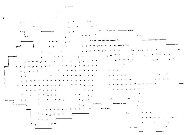
LAC ICHKEUL (TUNISIE) SOUMIS A L'ACTION D'UN VENT VARIABLE (7 et 8 Septembre 81) DIAGRAMME DES VITESSES APRES 2700 PAS DE TEMPS
