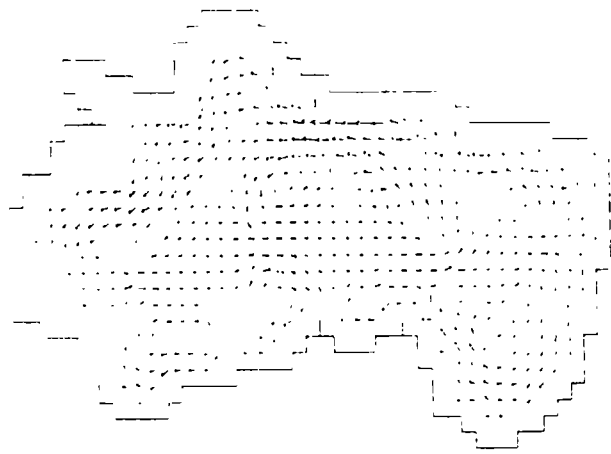
LAC ICHKEUL (TUNISIE) SOUMIS A L'ACTION D'UN VENT VARIABLE (7 et 8 Septembre 81) DIAGRAMME DES VITESSES APRES 1060 PAS DE TEMPS
