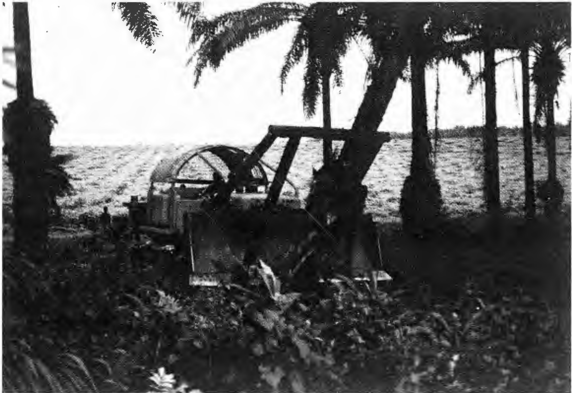
Fig.III.9 - Abattage d'un palmier par poussage à l'aide d'un tracteur à chenilles. A l'arrière plan se trouve une parcelle abattue l'année précédente.
