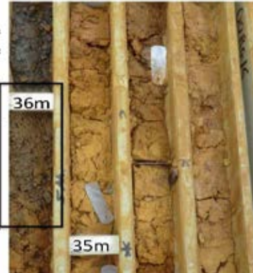
Figure 51 : Vue du niveau enrichi en carbone et tableau récapitulant les résultats des analyses de carbone total réalisées sur une sélection d'échantillons du profil S78 de Goro.
