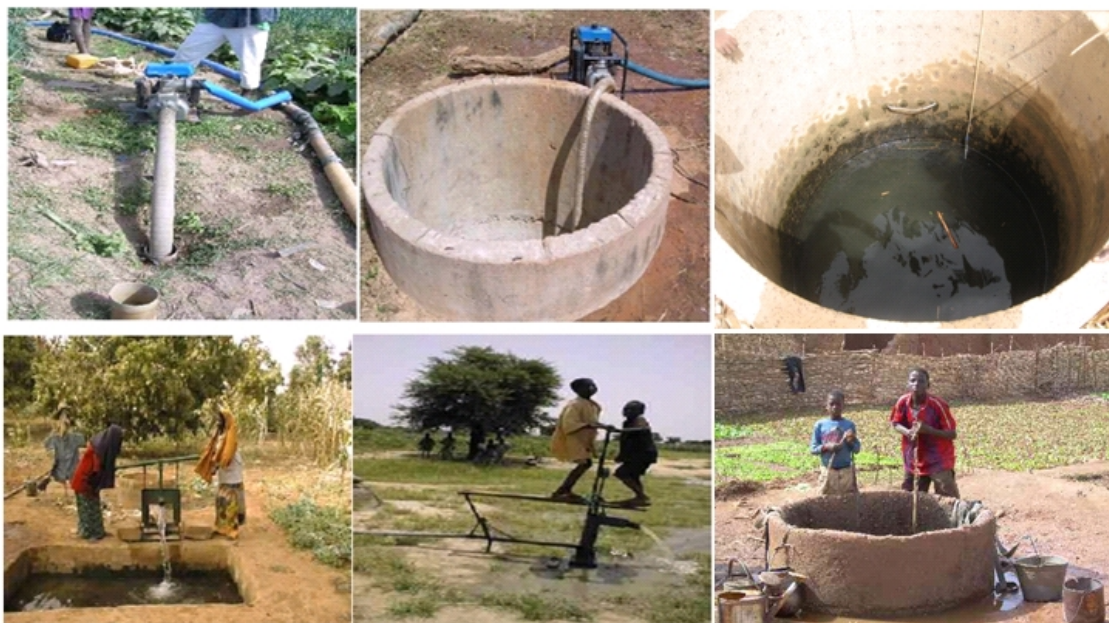
Figure 33 : Techniques de captage et d'exhaure à faible coûts, inventoriées dans le cadre de la petite irrigation privée. De gauche à droite : Forage manuel en PVC ; exhaure avec motopompe sur puits maraicher ; niveau d'eau dans un puits maraicher autour de mare de Tinga ; exhaure avec Pompe à la main, généralement utilisée par les femmes ; exhaure avec Pompe à pédale, exhaure avec puisette
