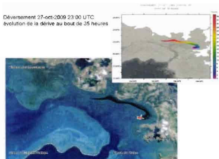
Figure 3 Exemple de prévision de dérive de nappe en baie de Gatope (Commune de Voh) réalisée dans le cadre de l'exercice POLMAR 2009. Prévision employant ADCIRC 2D sur la grille 65206 nœuds (J. Lefèvre)
