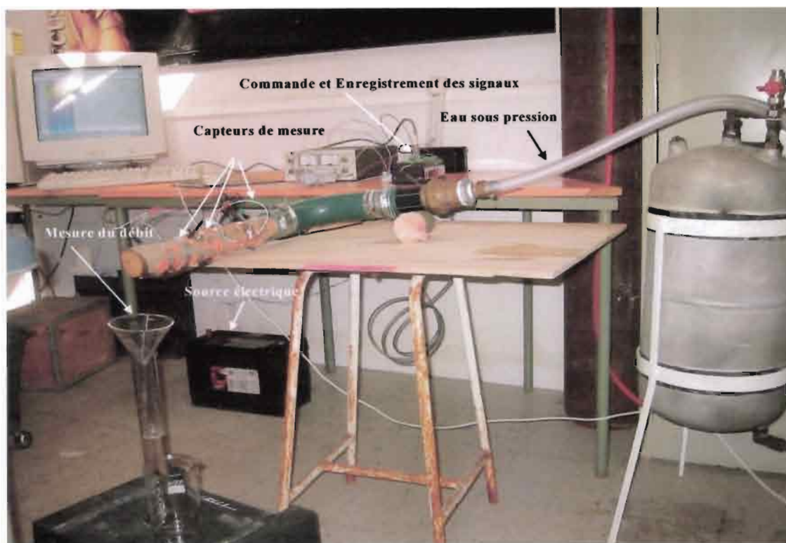
Figure IV.10. Dispositif d'étalonnage des capteurs de mesure du flux de sève sur une branche d'olivier au laboratoire.
