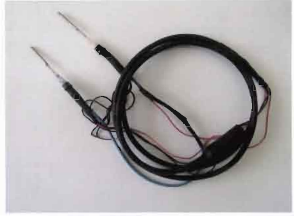
Figure IV.8.a. Sondes de fluxmètres à différentes étapes de la fabrication à Figure IV.8.b. Fluxmètre assemblé
