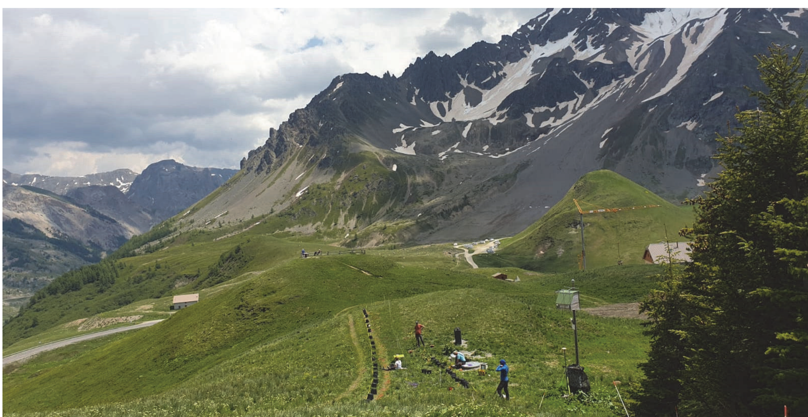
Mesures MASW à la station OGSA (Col de Lautaret).
