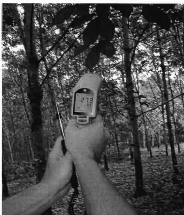
Rysunek n° 41 - Mesure de la température des feuilles à l'aide d'un thermoradiomètre ( T_{\text{feuilles}} , en °C) de type DTMX de Raytek®.
