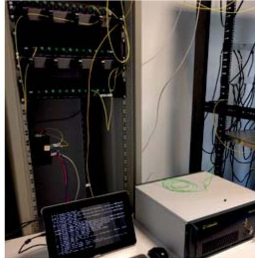
2 – Photo du système DAS de Febus Optics durant une mesure sur le câble fond de mer MEUST-NumerEnv au large de Toulon
