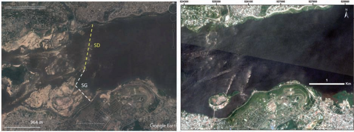
Figure 7. Vues satellites du fleuve Congo autour des premiers rapides du Djoué formant le contrôle hydraulique de la station hydrométrique de Brazzaville-Kinshasa, avec l'identification de la probable section de contrôle, en deux sections SD et SG, (sources : à gauche, Google Earth en mars 2022 et à droite, nano satellite Planet le 17/12/2019).
