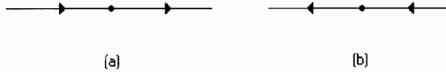
Figure 1.3 (a) Portrait de phase d'un shunt positif. (b) Portrait de phase d'un shunt négatif.
