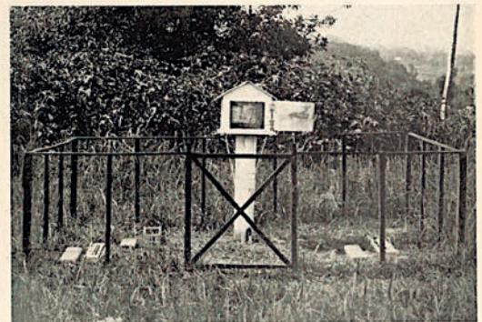
Station de Phu-Hô : le géothermomètre enregistreur et les thermomètres pour l'étude de la température de l'air près de la surface du sol.
