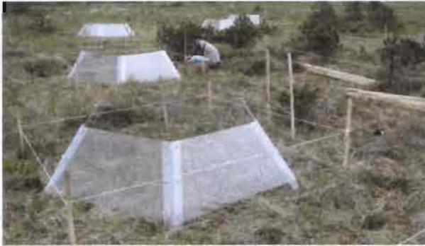
**Figure 6.3.** *Open Top Chambers (OTC), dispositifs de réchauffement artificiel de l'air et de la surface du sol installés dans la station expérimentale de la tourbière de Frasné (Jura) (source : F. Laggoun)*
