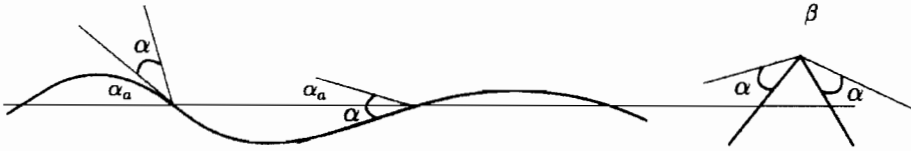
Figure 2.2. Variation de l'angle de contact macroscopique \alpha_a par rapport à la surface moyenne. Pour une surface présentant des angles, à droite, \alpha_a est compris entre \alpha et \alpha + \beta
