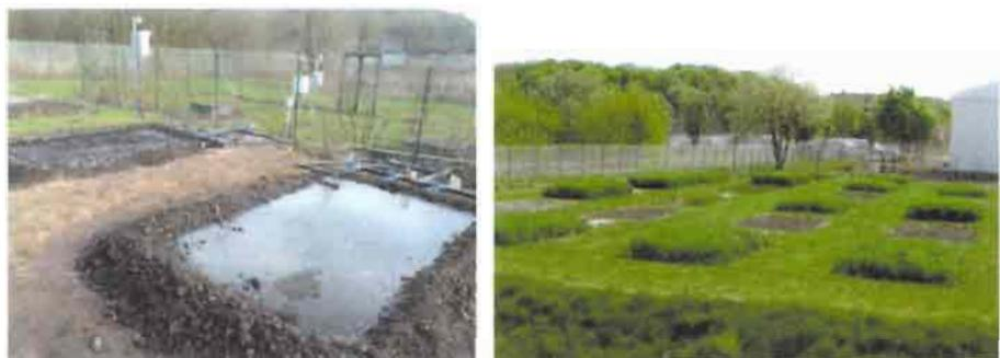
**Figure 7.6.** Photos illustrant des techniques de remédiation des sols contaminés par des HAP (à gauche : essai d'oxydation chimique *in situ* ; à droite : essais d'atténuation naturelle assistée par des plantes (Homécourt, GISFI)) (photos : P. Faure, C. Leyval).
