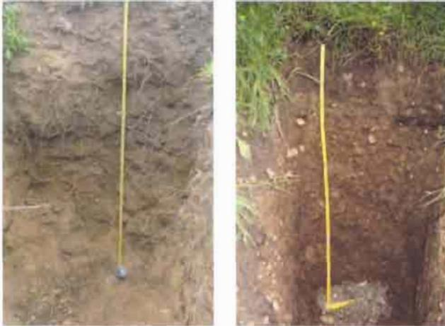
**Figure 8.10.** Exemple de profil de sols reconstitués, Cité internationale de Lyon, à gauche en 1994 lors de la mise en place ; à droite en 2012 (programme Sciencil) (photos : J.-P. Rossignol et L. Vidal-Beaudet)
