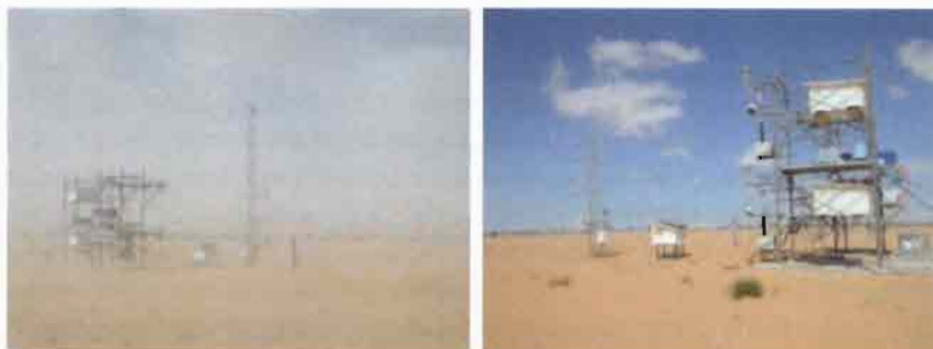
Figure 3.15. Dispositif de mesure des flux verticaux d'aérosols terrigènes par la méthode des gradients au cours d'une campagne de terrain au sud de la Tunisie en mars-avril 2017 (projet ANR WIND-O-V 4 ). Noter le mât équipé de profils d'anémomètres à coupelles, d'anémomètres soniques 3D et de thermocouples pour mesurer les paramètres dynamiques et les échafaudages permettant de collecter les aérosols en fonction de leur taille à deux niveaux (photo de gauche) et permettant de mesurer en continu leur concentration par classe de taille et leur concentration massique, également à deux niveaux (photo de droite) (photos : IRD, J.L. Rajot).
