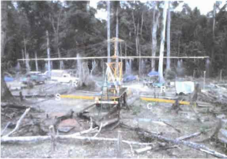
Figure 3.8. Simulateur de pluie rotatif de type Swanson, arrosant 200 m 2 dans lesquels sont implantées deux parcelles de mesure du ruissellement et de l'érosion de 10 m de long et 5 m de large permettant de comparer deux traitements, ici : un sol nu travaillé dans le sens de la pente (traitement standard, S) et un champ destiné au riz pluvial après abattis-brûlis (C). Deux pluviomètres linéaires (R), jaunes sur la photo, permettent de s'assurer de l'homogénéité de la pluie sur les parcelles [COL 84], forêt de Taï, Côte d'Ivoire (photo : C. Valentin).
