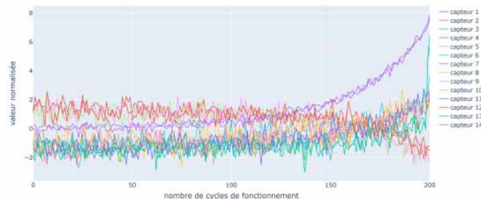
FIG. 2 – Valeurs normalisées en fonction du nombre de cycles pour le moteur #9
