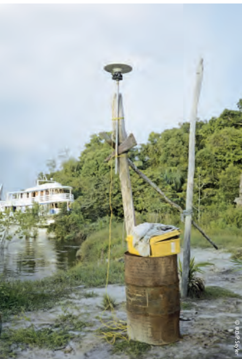
Calibração das medições via satélite com medições in situ por GPS: campanha Rio Negro, maio de 2005.
