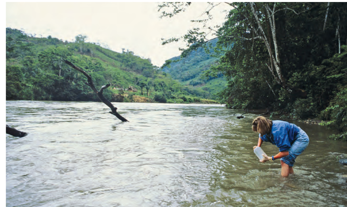
Amostras de água do rio Challana no sopé dos Andes bolivianos, usando protocolos de ultra limpeza, para a análise de metais traças incluindo mercúrio (lavagem de garrafas de teflon em banhos ácidos, usando luvas sem talco de uso único).
