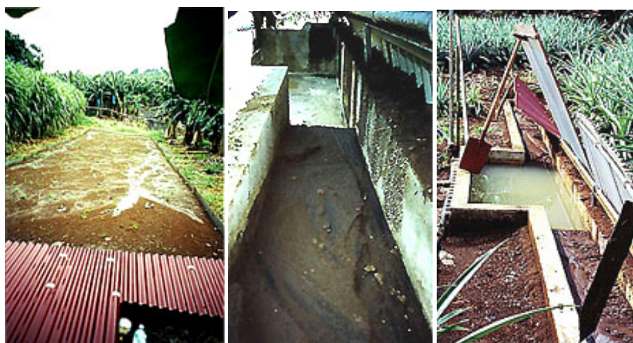
Photo 18. 1. Série de clichés pris sur les phénomènes observés sur les traitements testés. Ruissellement sur le sol nu (Nu11) – Détail des sédiments érodés et piégés dans le canal collecteur et dans la cuve de
