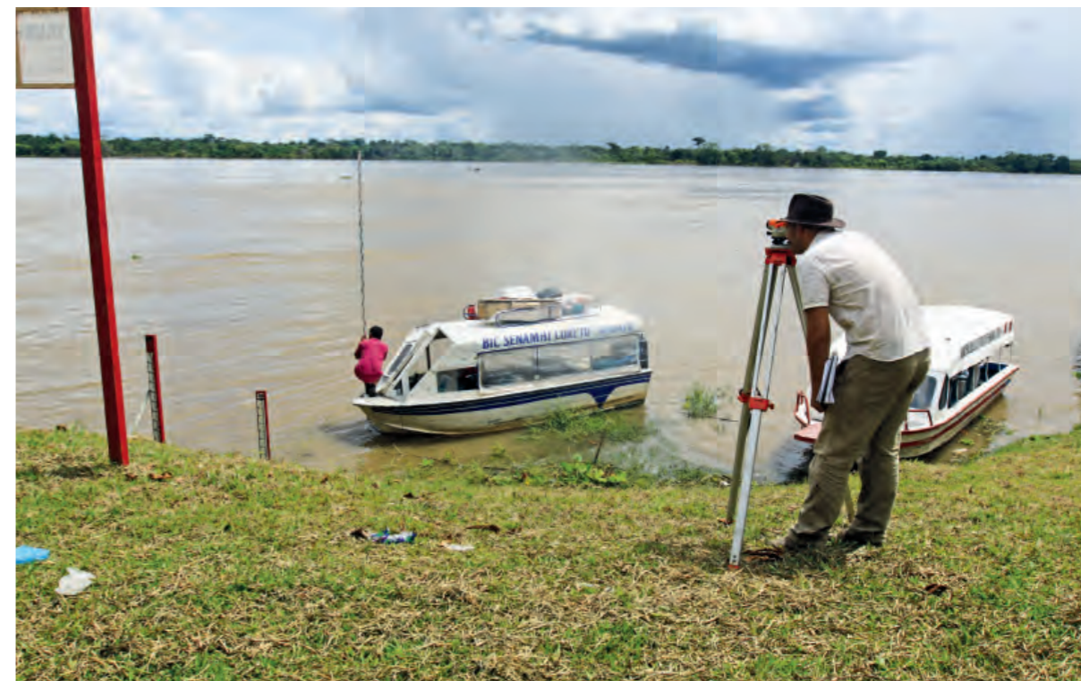
Medição do nível da água na Amazônia (programa HyBam), Peru.
