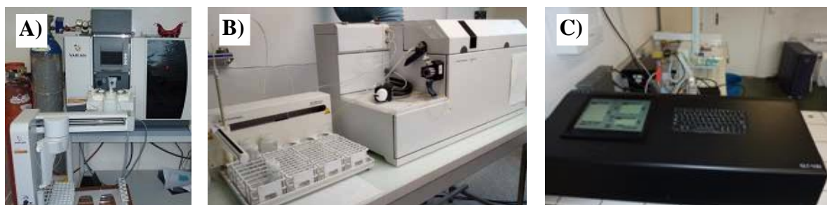
Figure I.30 : Appareils de mesures sur les eaux A) Spectromètre d'absorption atomique (GEOPS - Géosciences Paris Sud, 2018), B) Spectromètre de masse à plasma à couplage inductif et C) Spectromètre d'absorption laser LGR (GEOPS - Géosciences Paris Sud, 2018)
