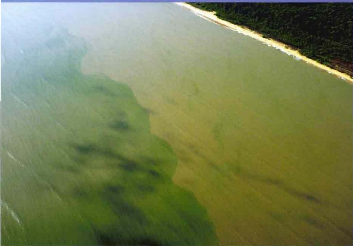
Les eaux turbides envasées proches du littoral s'étendent sur plusieurs centaines de mètres de large et sont visibles par image aérienne alors que les eaux côtières apparaissent plus claires. Une interprétation de ces variations de la couleur de l'eau mesurée via l'imagerie satellitaire permet une estimation quantitative de la concentration d'une variété de composés biogéochimiques.
