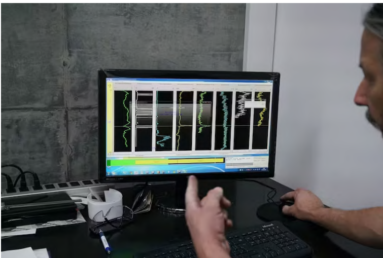
Les variations du sédiment à l'intérieur de chaque section apparaissent sur l'écran du scanner. Moises Saman/Magnum Photos, CC BY-NC-ND
