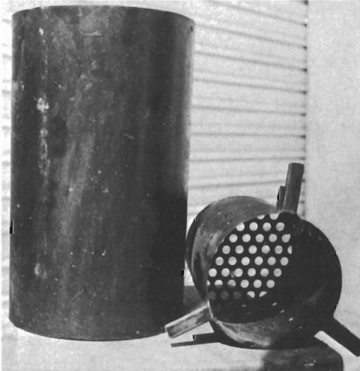
FIG. 31. — Piège à anhydride carbonique (2<sup>e</sup> dispositif).
